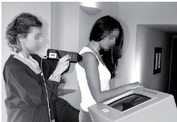
Figura 1 - Skin analyser QTan (Flyby s.r.l., Livorno): uno spettrofotometro multibanda dermatologico di 400-1400 nm, con microprocessore e display LCD incorporati, che consente la determinazione istantanea e non invasiva della MED attraverso la misura della riflettanza cutanea nella banda del visibile e del vicino infrarosso, con acquisizione istantanea della misura della quantità relativa di melanina e della quantità relativa di emoglobina.
